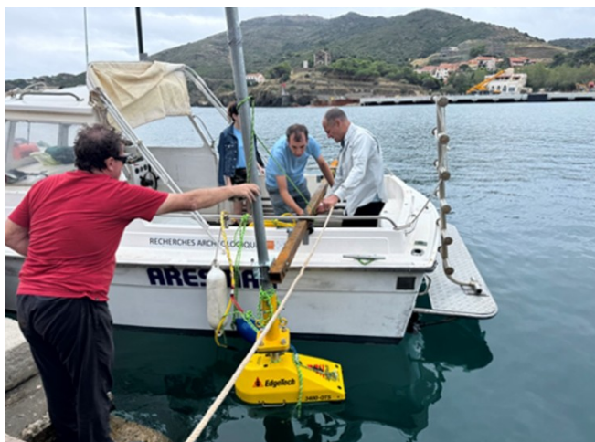
Installation du profileur de sub-surface fixé au bateau (clichés : Michael LAZAR ).
